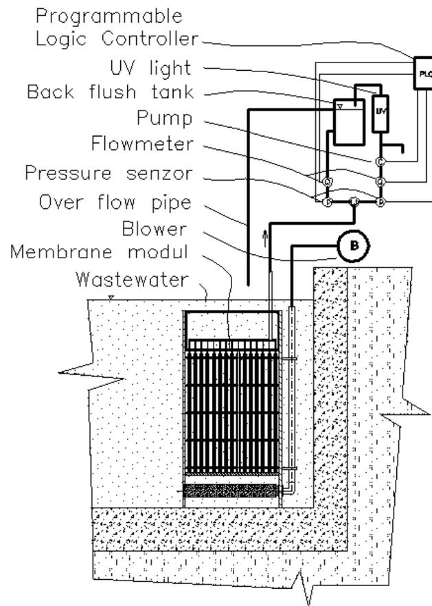
Fig. 3: Pilot test apparatus
